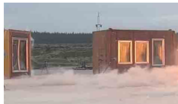
Oben: kontrollierte Explosion Mitte: Auswirkungen der Druckwelle auf die Schüco Fassade Unten: Auswirkungen der Druckwelle auf die Schüco Fenster und Türen Top: the controlled explosion Next: progress of the blast wave showing the Schueco façade deflecting Bottom: progress of the same blast wave showing its impact on Schueco windows and doors
